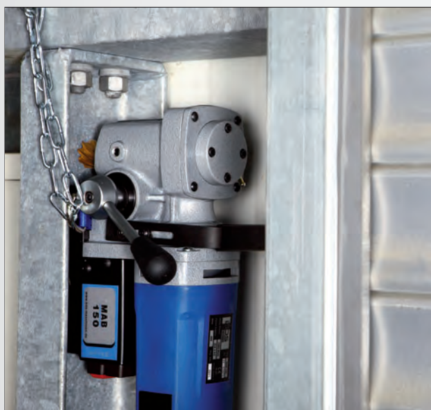
Станок MAB 150 может использоваться для сверления отверстий до \varnothing 35 мм даже в самых стесненных условиях.
