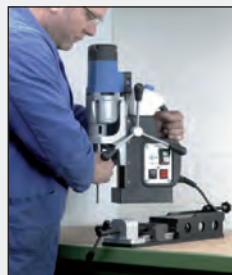
MobilCLAMP в работе в качестве настольного сверлильного станка
