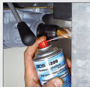
Этап 2: Во время сверления распылите высокопроизводительный смазочный спрей на конец сверла и внутрь отверстия.
